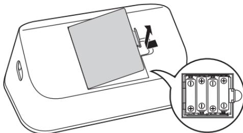
2. **Insérer quatre piles « AA » dans le compartiment des piles en suivant les indications.**
