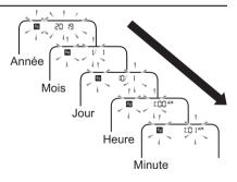
**4.** Appuyer sur la touche 3 pour enregistrer le réglage. Le tensiomètre s'éteint automatiquement trois secondes après le réglage des minutes dans cette séquence.
